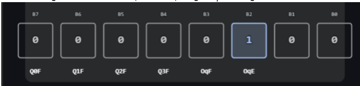
Figura 5. Câmpurile registrului STATUS
