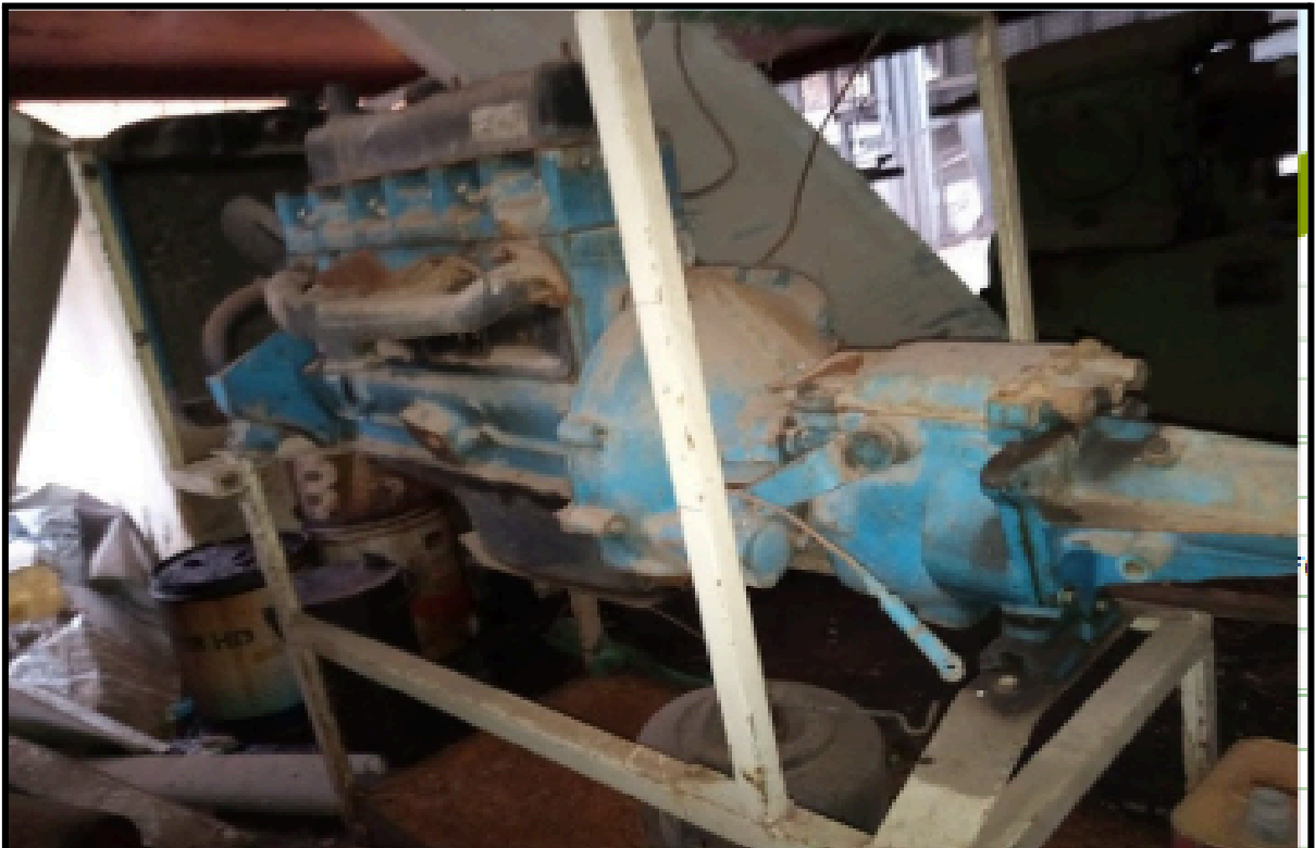
Figura 37 - Motor diesel 6 cilindros abandonado
