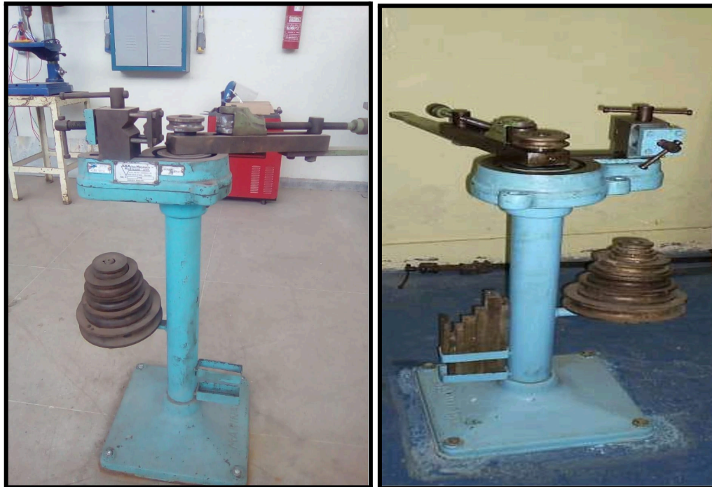
Figura 42 - Curvador de tubos em 2025 e em 2008
