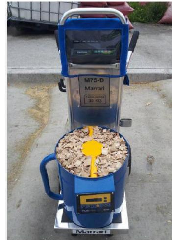
Una vez registrado el número de bits, de la misma muestra analizada, cuyo volumen es igual a 35 litros, se deben recolectar submuestras para análisis de humedad en el laboratorio, siguendo la norma NBR 14929 (ABNT, 2017). Por lo tanto, el material debe verterse sobre una
