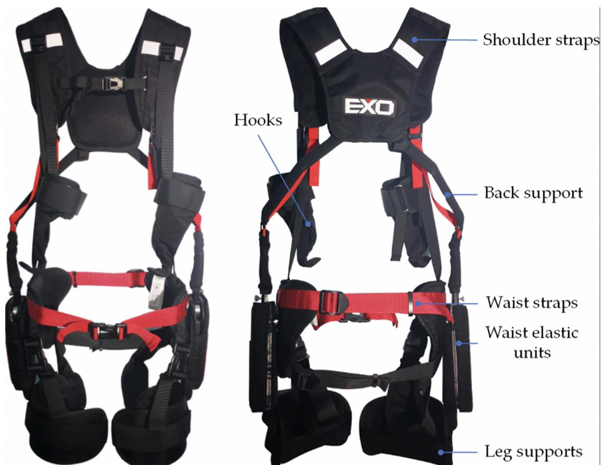
Конструкция пассивного экзоскелета
