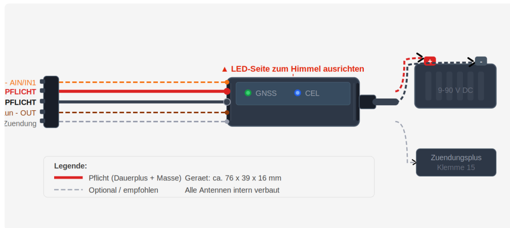
Abb. 1: Anschlussschema vc|fleet – Kabelfarben und Anschlusspunkte
