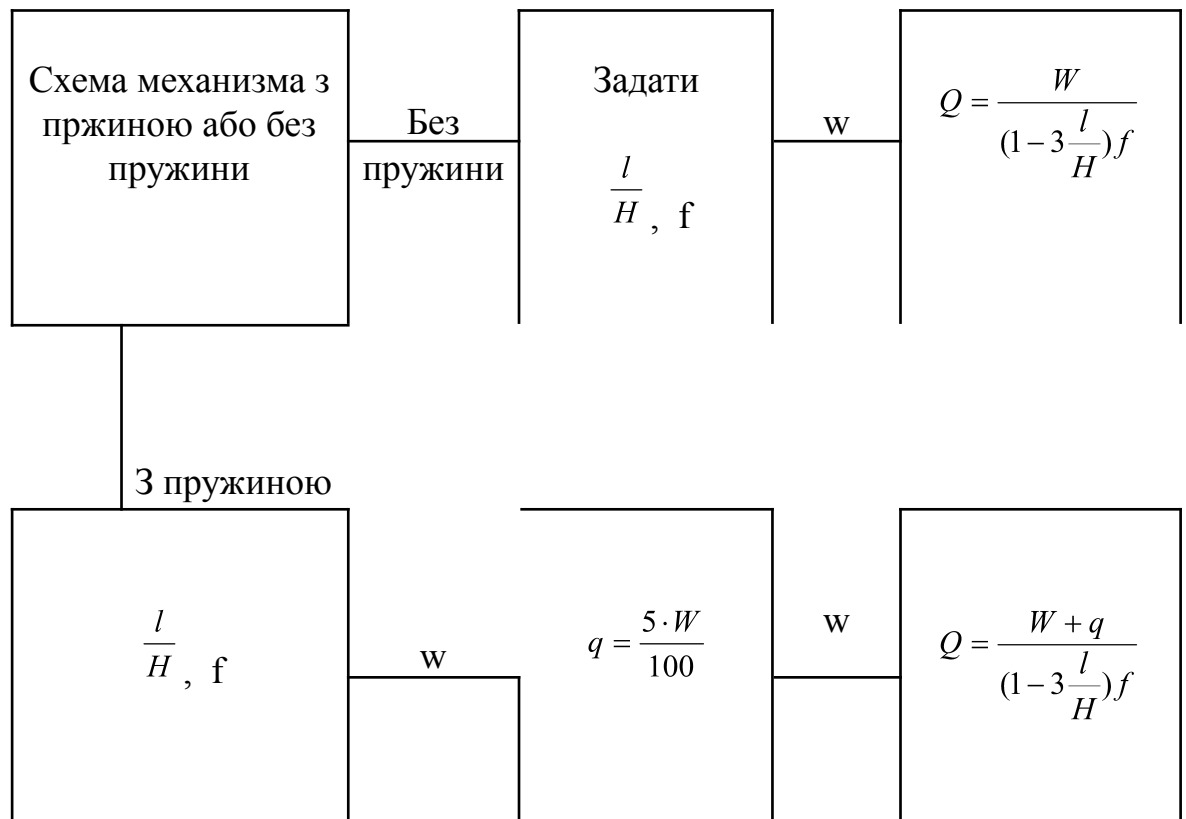
Рис. 14. Алгоритм розрахунку Г - подібного прихвату.
