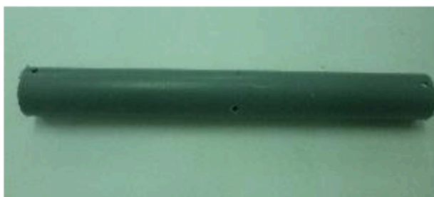
Bước 3. Ống nhựa PVC được khoan các lỗ tròn 3 mm ở hai đầu và trung điểm
