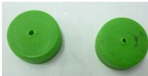
Bước 2. Nắp chai nhựa được khoan lỗ tròn 3 mm
