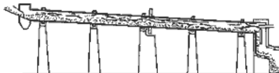
c) Calcinación de la harina cruda y obtención del clinker
