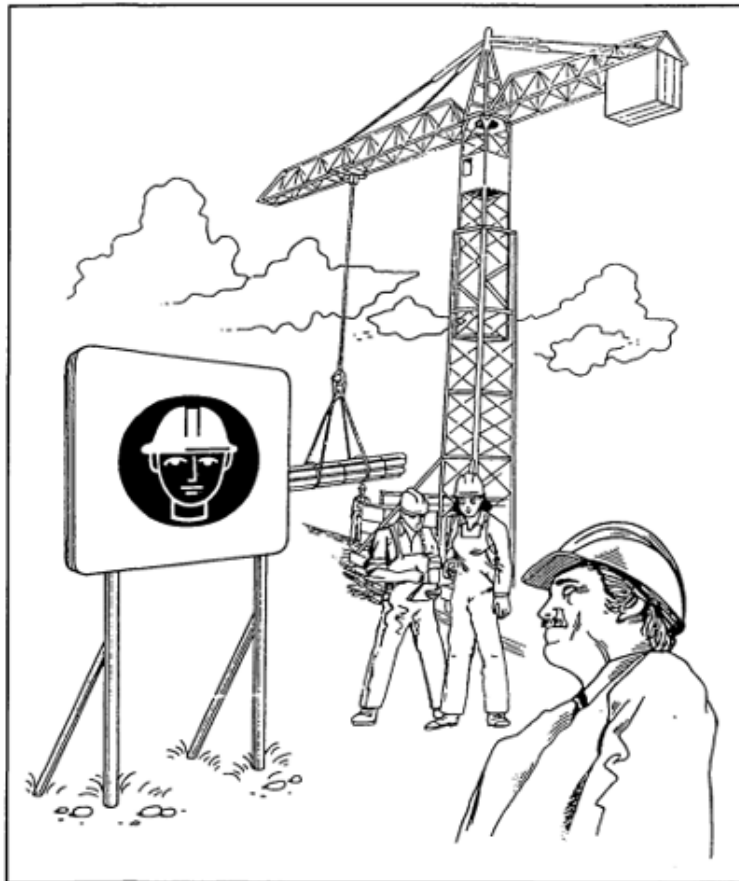
Figura 2. Zonas de cascos. Todas o casi todas las partes de una obra en construcción deben estar marcadas como zonas donde el uso de casco es obligatorio
