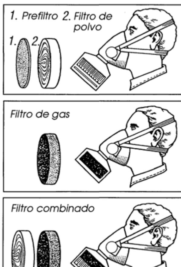
Figura 4. Tres tipos de media máscara con filtros
