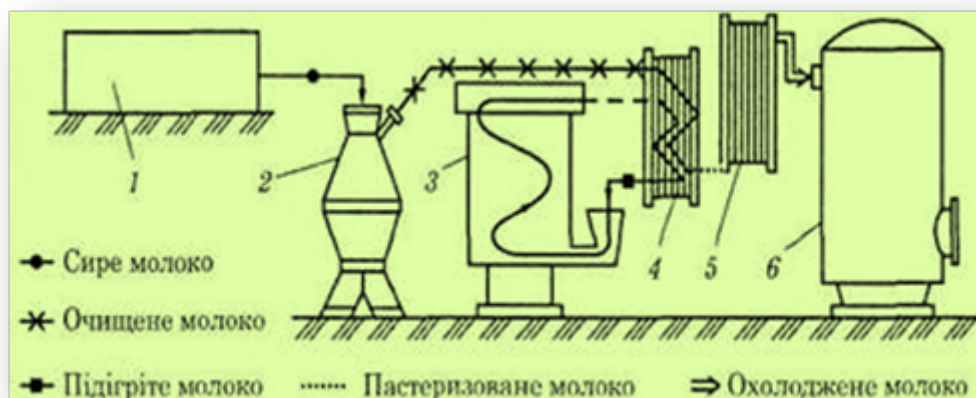
Рис. 9.1. Технологічна схема первинної обробки молока:
