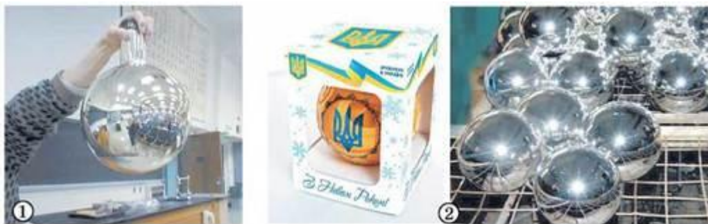
Рис. 19.3. 1. Реакція «срібного дзеркала»: блискучий результат! 2. Магія виготовлення ялинкових прикрас ґрунтується на хімічному перетворенні
