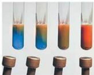
Рис. 19.4. Окиснення альдегіду свіжодобутим купрум(II) гідроксидом. На цій реакції ґрунтується метод визначення моносахаридів у біологічних рідинах, зокрема в крові й у сечі, винайдений німецьким хіміком Карлом Августом Троммером у 1841 році
