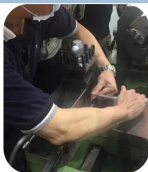
圖1-操作內六角扳手正確動作
