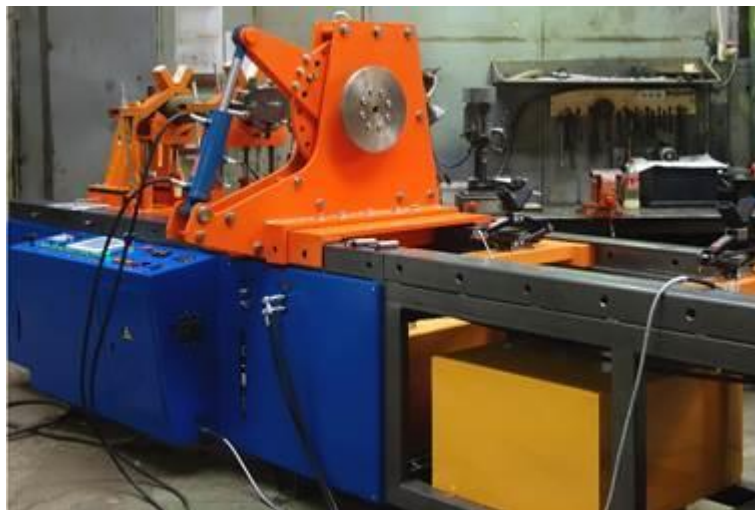
Рис. 4.127. Стенд для випробування гідравлічних циліндрів СТИГ-10М
