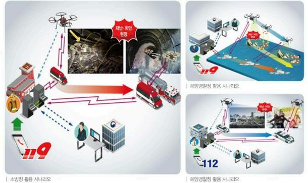
3가지 타입의 재난치안용 드론은 공통적으로 강한 내풍성능, 방수방진 성능을 가지고 있으며, 장애물 회피센서(LiDAR)가 탑재되어 비행안전에 초점을 맞추었다. 아울러, 재난치안용 드론에 탑재되는 장비들은 소방청, 해양경찰청, 경찰청에서 요구한 드론활용 시나리오에 따라 무허가지, 유해물질탐지 장치, 방사능 측정장치, 스미커, 탐조등 등을 개발한다.
