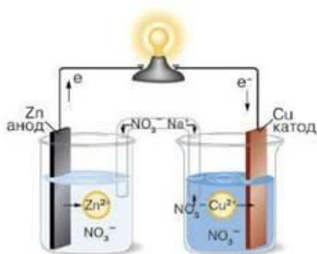
Рис. 31. Схема гальванічного елемента Даніеля-Якобі
