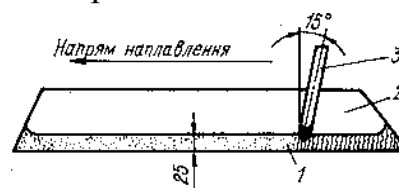
Рис. 280. Схема електродугового нап- лавлення леза лемеша порошкоподібним твердим сплавом: 1 — шихта; 2 — леміш; 3 — графітний електрод.
