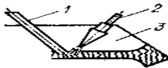
Рис. 279. Схема наплавлення леза газового пальника:
