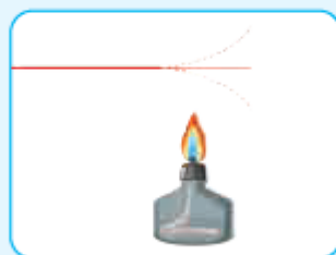
Gamabr 3.15 Percobaan bimetal sederhana.
