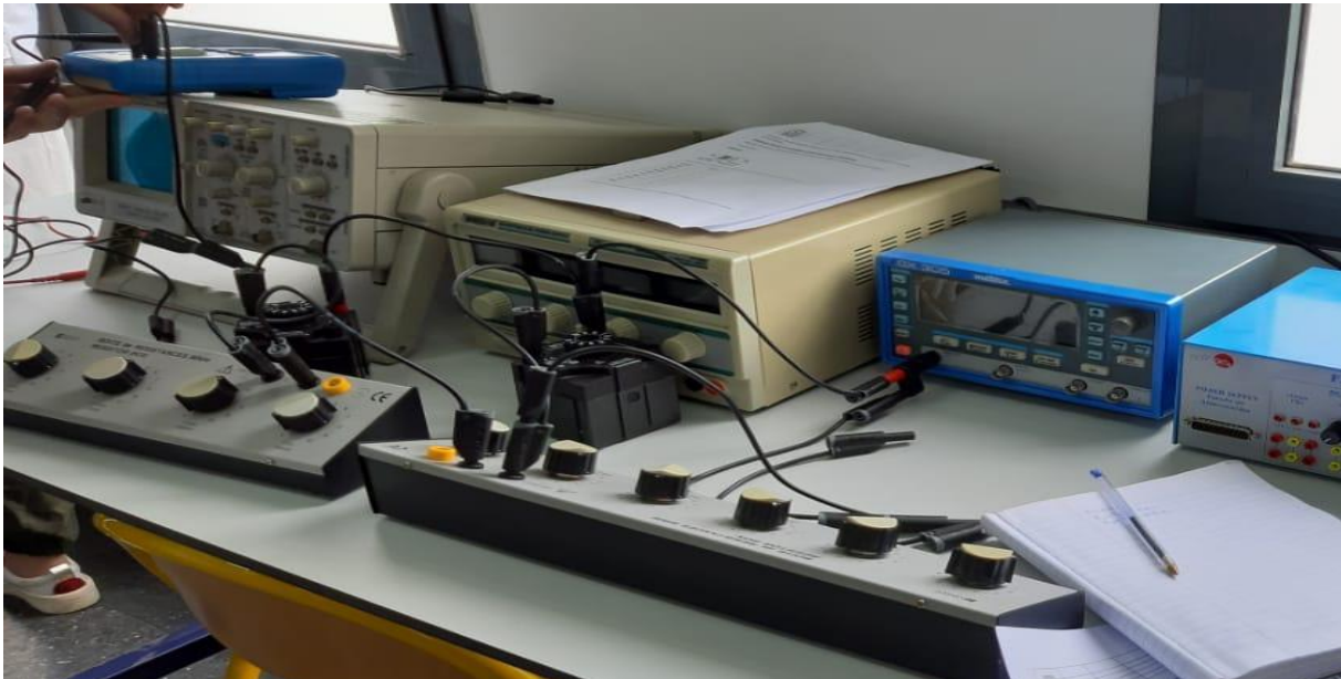
Figure 4 : Le Montage aval réalisé lors du TP
