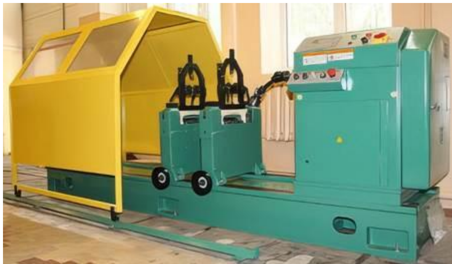
Рис. 6.7. Стенд для балансування барабанів та роторів 9Д716
