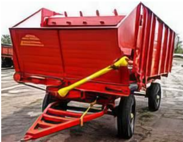
Рис. 6.5. Машини для роздачі кормів КТУ-10 та «Брацлав»
