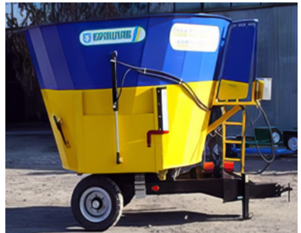
Рис. 6.5. Машини для роздачі кормів КТУ-10 та «Брацлав»
