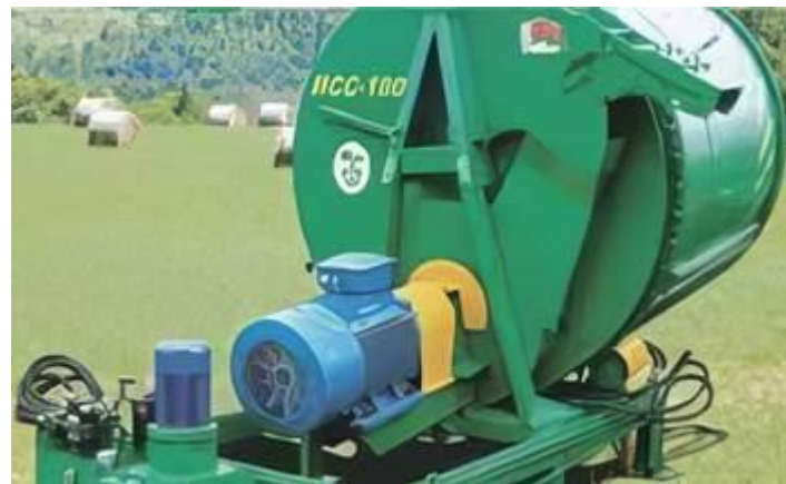
Рис. 6.3. Машини для подрібнення грубих кормів ИРК-145 та ИСС-180
