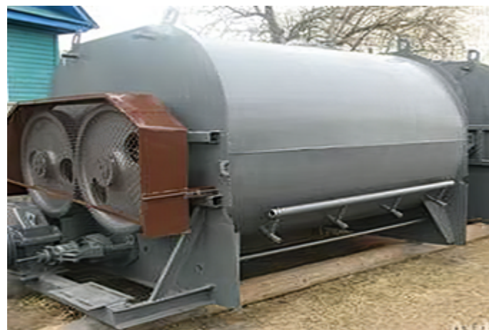
Рис.6.6. Обладнання для запарювання та змішування кормів ЗПК-4 та С-12:
