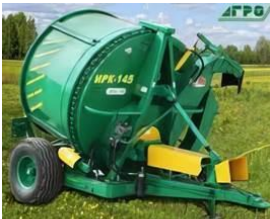
Рис. 6.3. Машини для подрібнення грубих кормів ИРК-145 та ИСС-180
