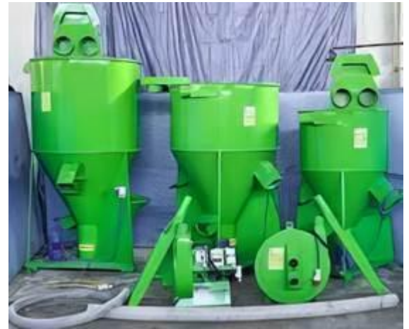
Рис. 6.4. Машини для подрібнення зернових кормів ВЗСК-1000 та ДЗК-1
