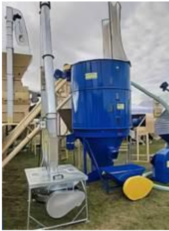
Рис. 6.4. Машини для подрібнення зернових кормів ВЗСК-1000 та ДЗК-1
