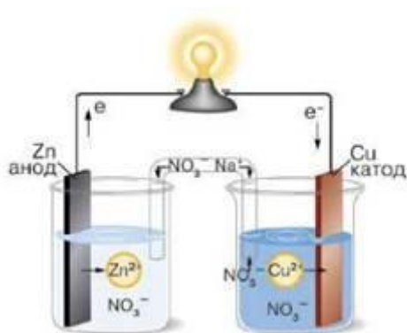
Рис. 31. Схема гальванічного елемента Даніеля-Якобі
