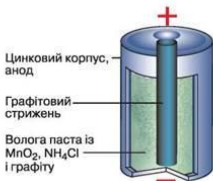
Рис. 32. Будова сухого гальванічного елемента
