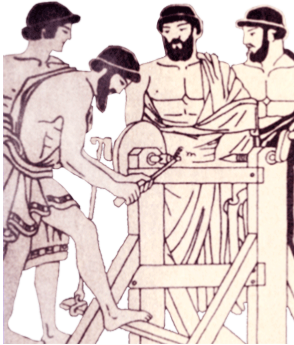
Рис. 4. Токарний верстат грецького майстра Феодора (VI ст. до н. е.)
