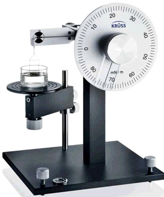
Рисунок 21 – Тензиометр KRÜSS K6
