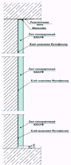
После нанесения клея-шпаклевки, КНАУФ-лист поднимается, устанавливается на подкладки, прижимается к стене и выравнивается с помощью отвеса или уровня.
