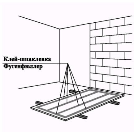
К ровным поверхностям приклеивание осуществляется путем нанесения тонких сплошных полос гипсового клея-шпаклевки КНАУФ-Фуген.
