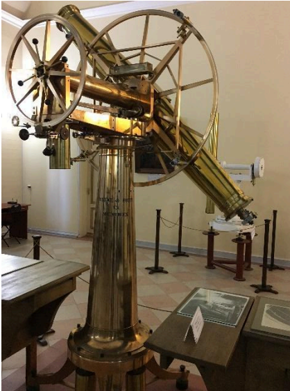
Foto 5. Meridiansirkelen i Pulkovo-observatoriet, fra 1830-årene. Produsent Ertel und Sohn, München. Foto Dan Norin, Lantmäteriet.
