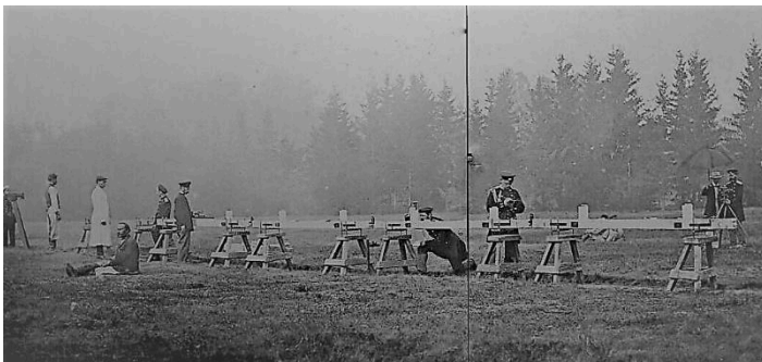
Foto 12. Eksempel på grunnlinjemåling med Struves utstyr. Foto Pulkovo-observatoriet.
