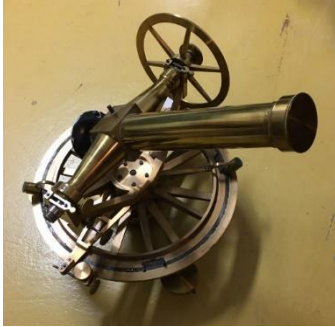
Foto 7. Teodolitten fra Littman, produsert i Stockholm i 1834. Foto Dan Norin, Lantmäteriet.
