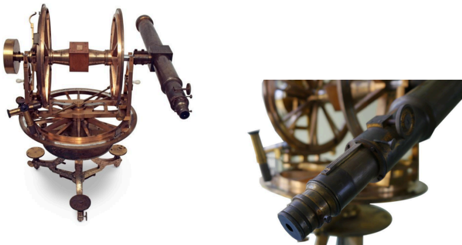
Foto 2-3. Et universalinstrument fra Reichenbach-Ertel fra 1820–1822. Universitetet i Göttingen.
