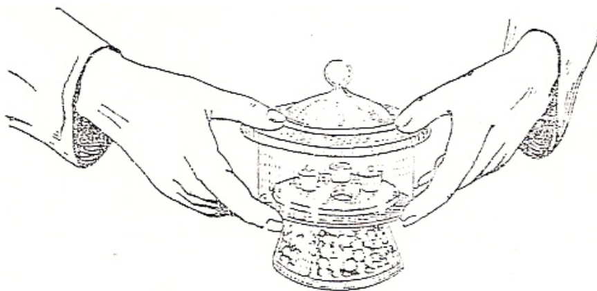
Рис. 1.45. Положення рук під час перенесення ексикатора
