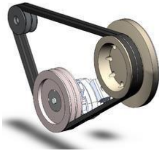
Рис. 4.1. Два паси, ведучий шків, ведений шків та натяжний ролик клинопасової передачі
