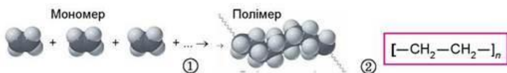
Рис. 28.1. 1. Полімеризація етену. Молекули етену - мономери. Поліетен - полімер. Показано лише фрагмент полімерного ланцюга, бо реальні розміри макромолекули не дають змоги зобразити її модель повністю. 2. Ступінь полімеризації n - кількість елементарних структурних ланок у полімерному ланцюзі
