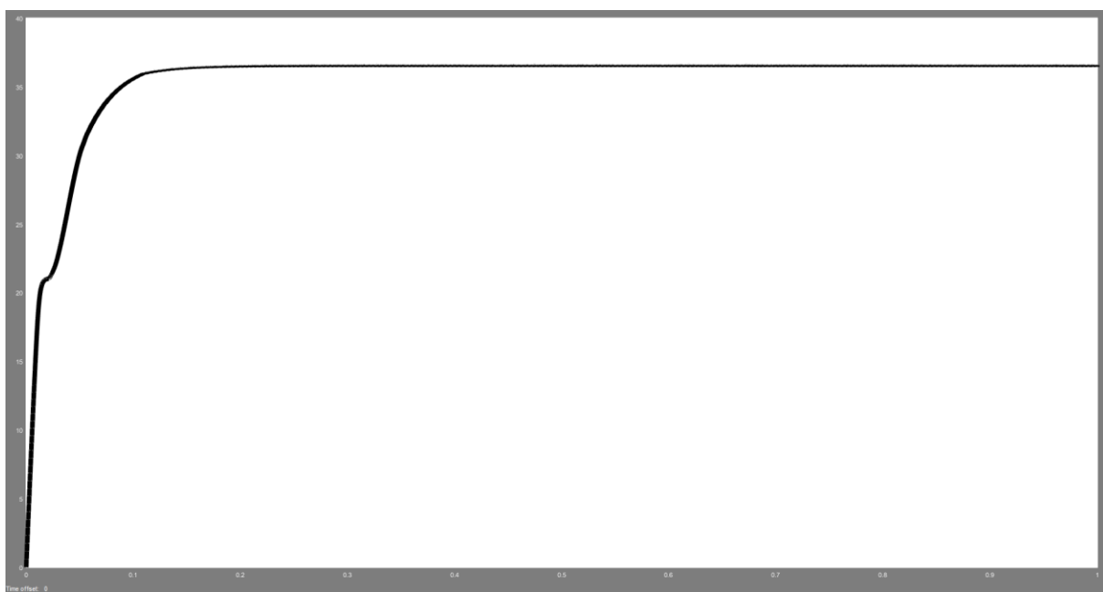
Hình 5.14: Điện áp ra của tấm pin với thuật toán P&O (36V)
