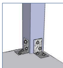
Detalle del ensamblaje de las patas al tablero.
