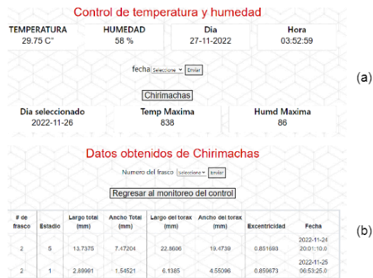
Figura 36. a) Interfaz web para el control de temperatura y humedad. b) Interfaz web para el monitoreo de los datos obtenidos en la adquisición de imágenes.
