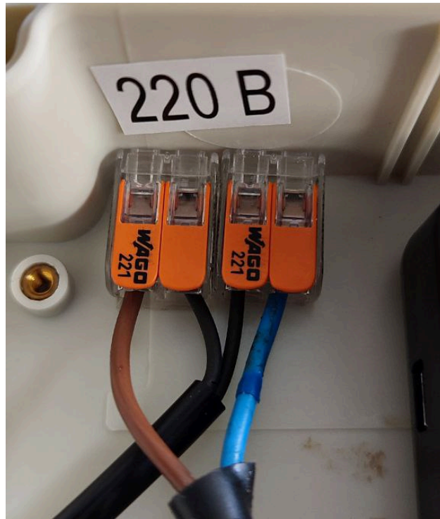
Рисунок 6 - Подключение провода источника питания к клеммам контроллера
