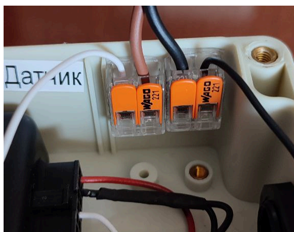
Рисунок 7 - Подключение провода датчика к клеммам контроллера
