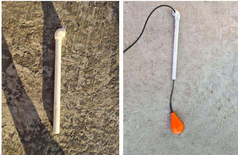
Рисунок 2 - Подготовка поплавкового датчика для монтажа в выгребную яму
