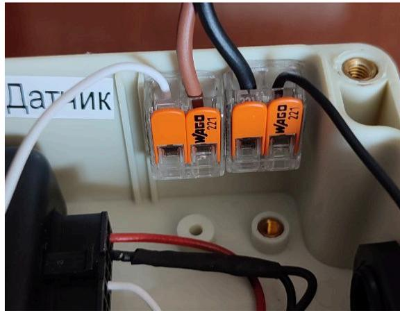
Рисунок 7 - Подключение провода датчика к клеммам контроллера
