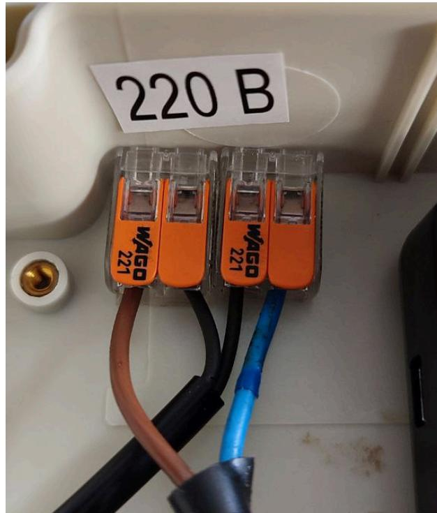
Рисунок 6 - Подключение провода источника питания к клеммам контроллера
