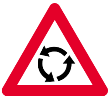
Advarselstavle for rundkørsel.
