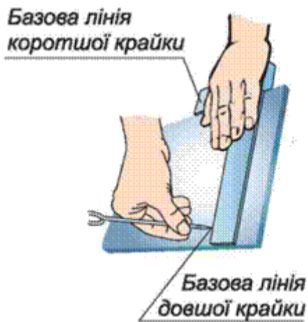
Мал. 6. Проведення базової лінії за допомогою кутника
