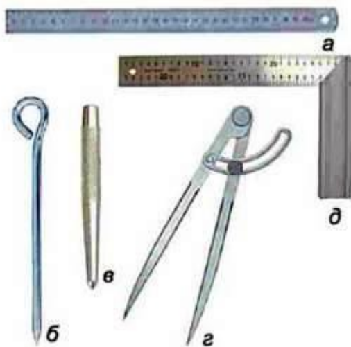
Мал. 2. Розмічальні слюсарні інструменти: а – масштабна лінійка; б – рисувалка; в – кернер; з – слюсарний циркуль; д – слюсарний кутник
