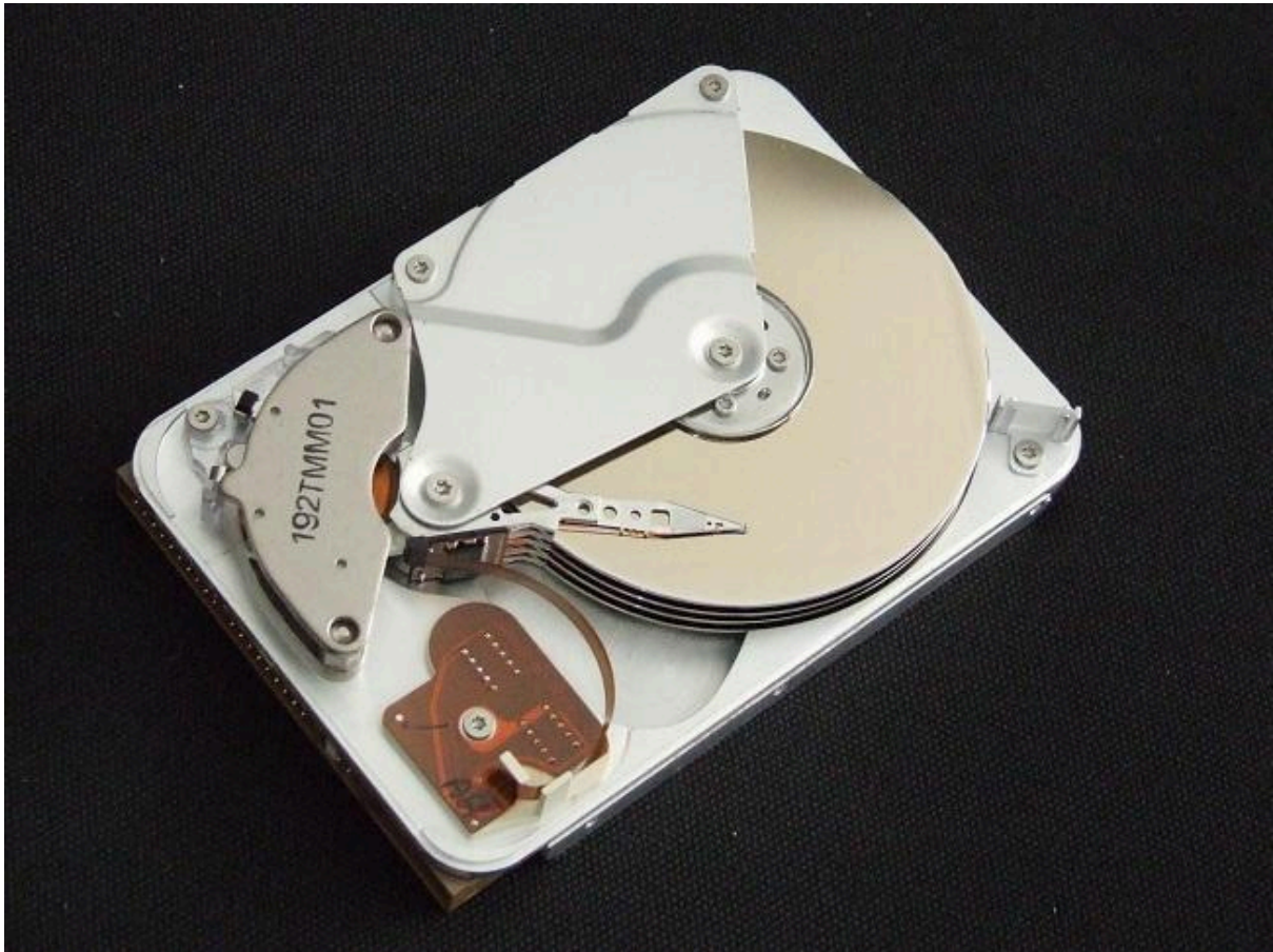
Afbeelding 10: Een harde schijf bestaande uit 4 schijven of platters
