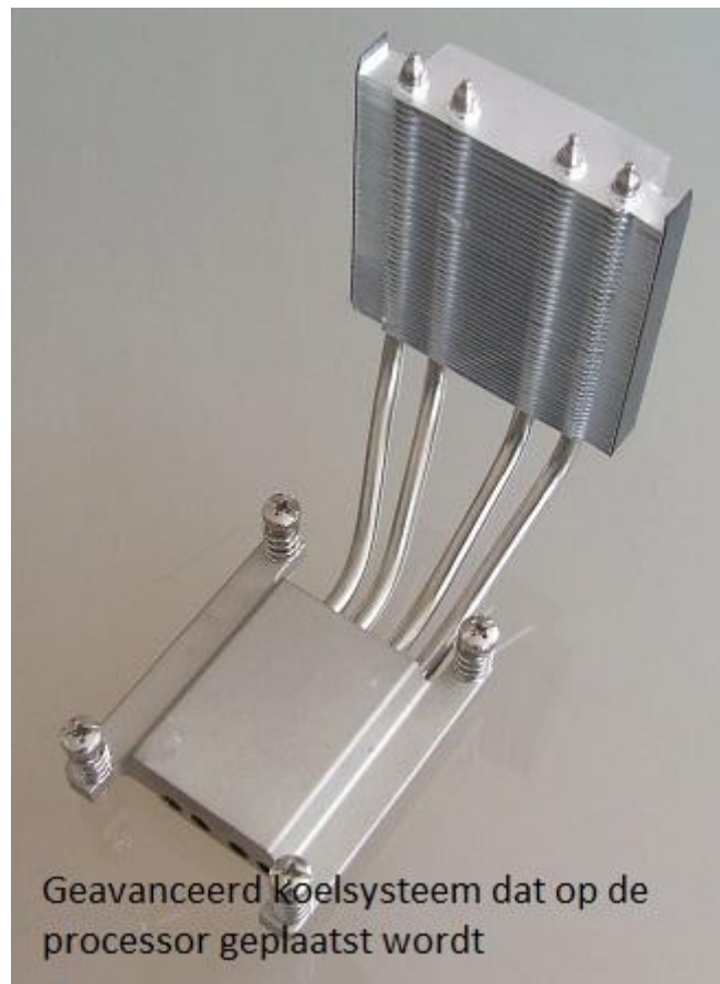
Afbeelding 6: Een koelsysteem om de warmte van de processor af te voeren
