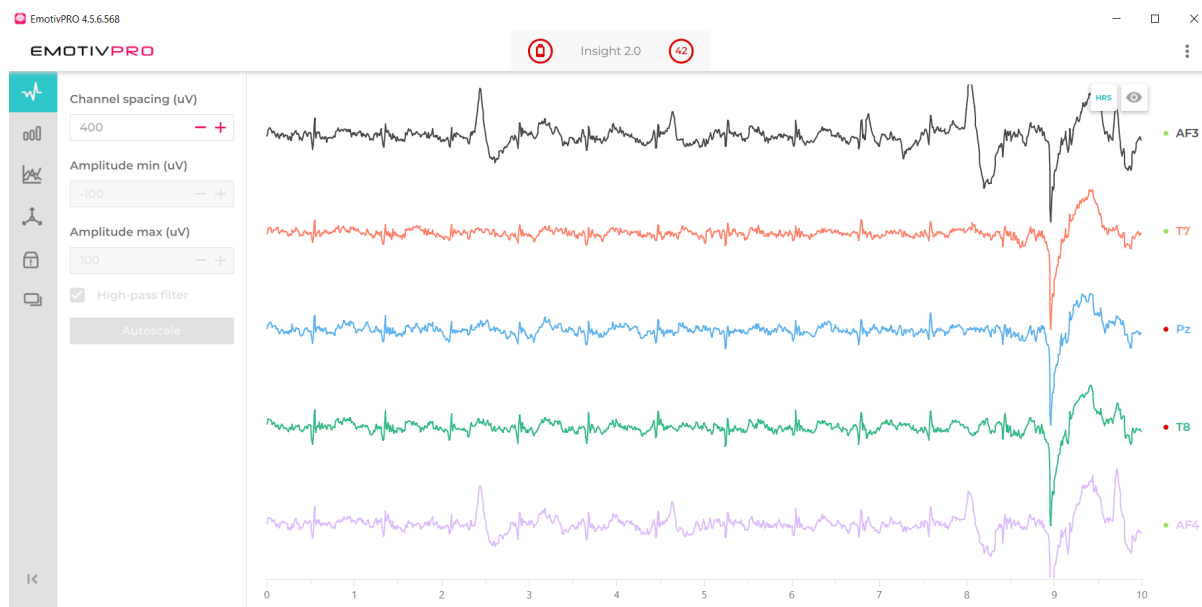
Figura 4: EEG obtenido por el Insight mediante la app EmotivPRO cuando el usuario mantiene su enfoque en el punto al lado de la sílaba “Pz” e inmediatamente después se aleja de la pantalla tras relajarse. Las caídas drásticas se dieron en el momento que se ejecutó la acción de movimiento, también se observa una caída significativa de la calidad de la señal.
