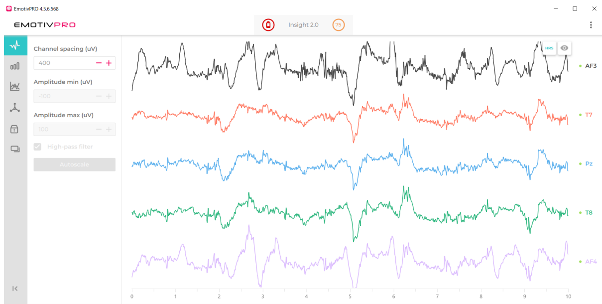
Figura 3: EEG registrado por el Insight en la app EmotivPro cuando el usuario mueve la cabeza ligeramente, en todas direcciones para cambiar constantemente el enfoque. En esta se aprecia una caída en la calidad de la señal obtenida.
