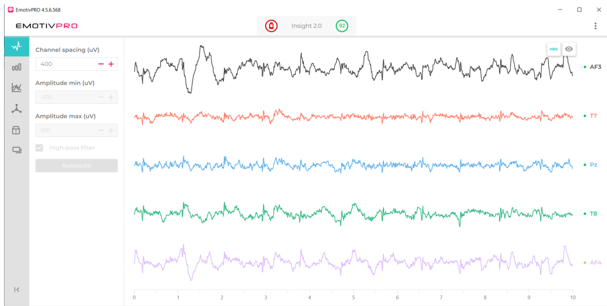
Figura 2: EEG registrado por el Insight en la app EmotivPRO cuando el usuario cambia constantemente el punto de enfoque únicamente moviendo los globos oculares y un estado relajado. No se observa cambios bruscos o caída significativa en la calidad de la señal
