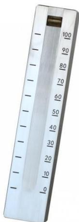
2. Измерительную плиту прибора устанавливают на горизонтальную поверхность. Испытуемый материал тщательно перемешивают и помещают за верхний предел шкалы приборов в количестве, достаточном для заполнения всего паза, избегая при этом попадания пузырьков воздуха
