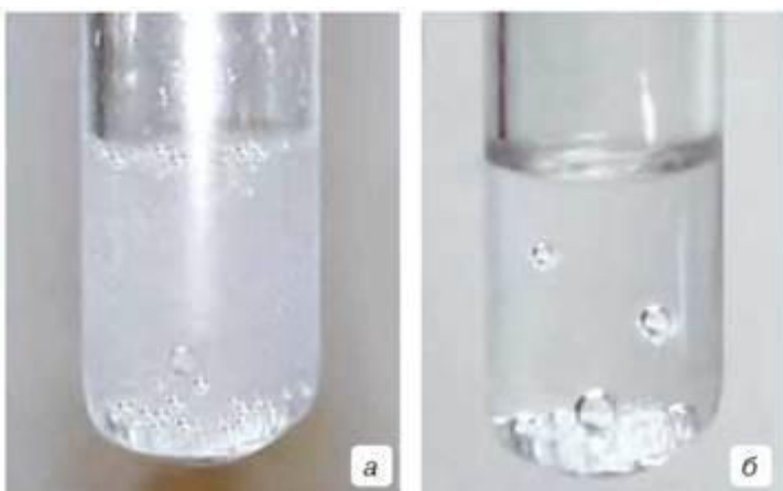
Мал. 52. Взаємодія алюмінію з кислотами: а — хлоридною; б — сульфатною
