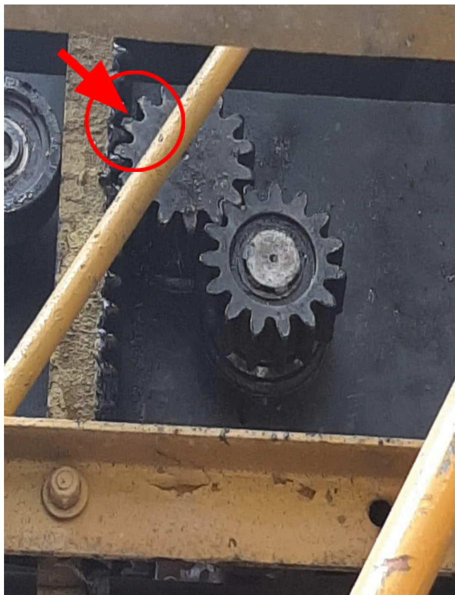
Figura 34 - Pinhão desgastado. Fonte: Autor
