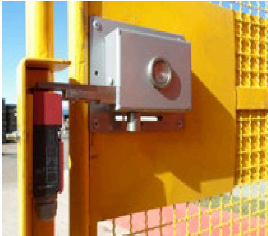
Figura 20 - Trava eletromecânica da porta da cabine. Fonte: Metax
