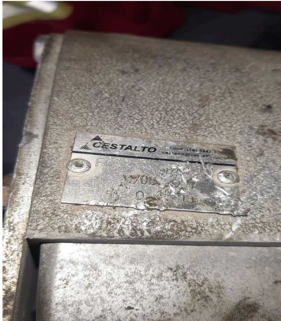
Figura 18 - Placa do freio amassada. Fonte: Autor
