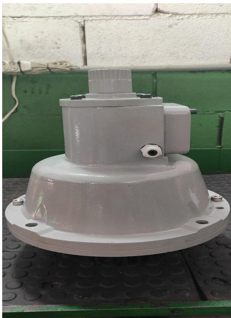
Figura 15 - Freio de segurança centrífugo. Fonte: Autor
