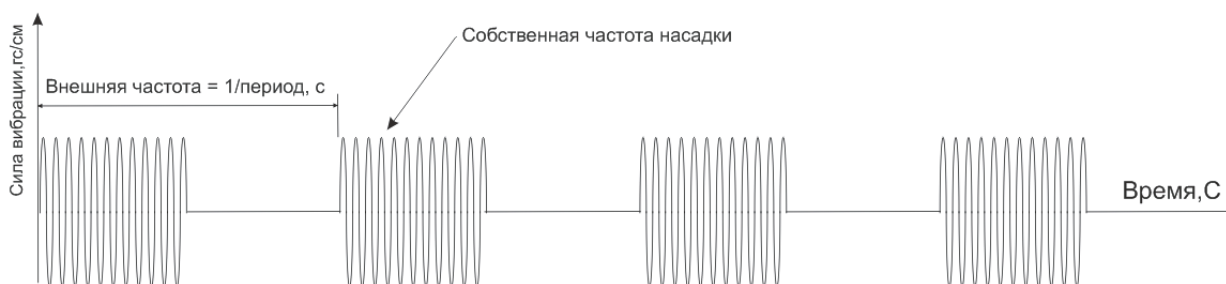
Рисунок 3. Временная диаграмма работы насадки в режиме ГЕНЕРАТОР
