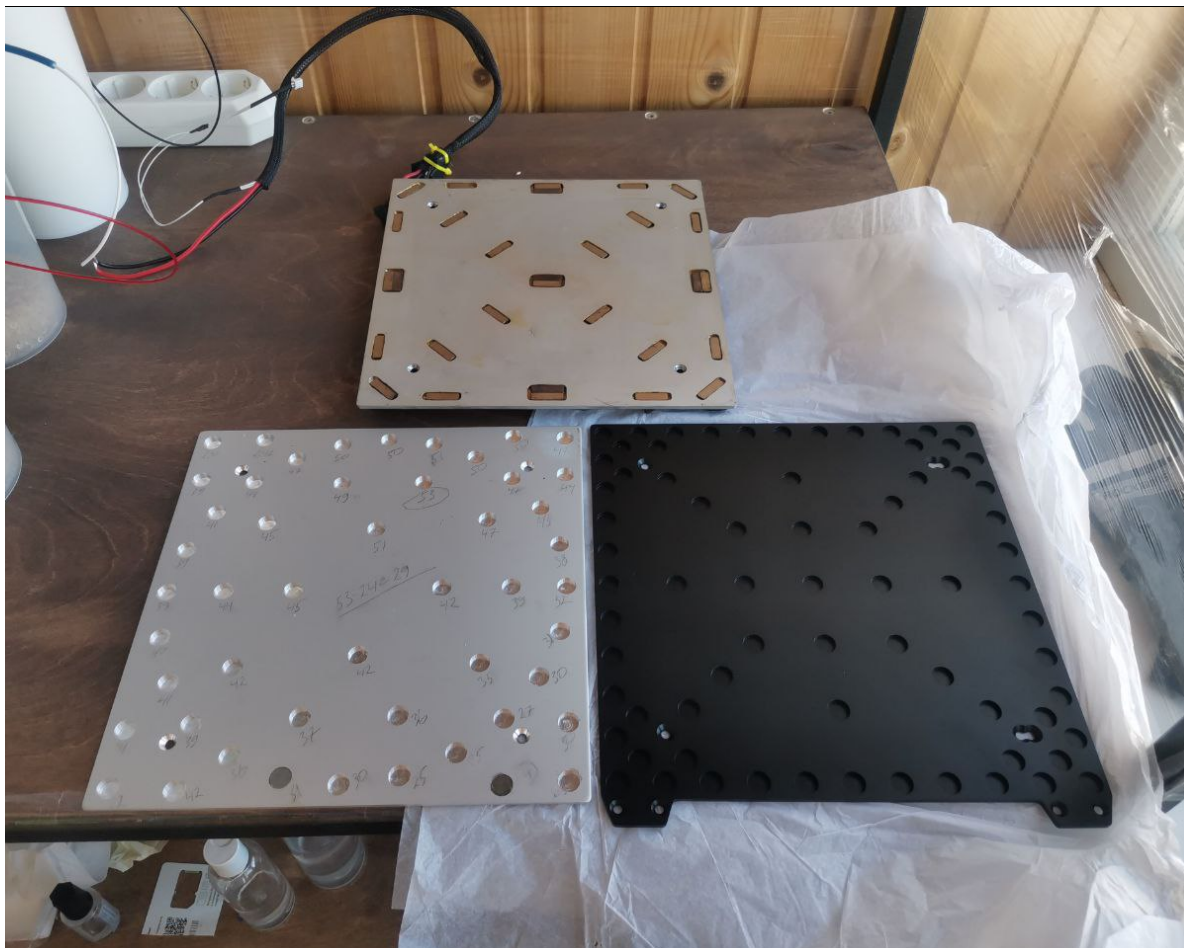
Рисунок 3 - столы Эмменталь трёх версий; V1 на 30 магнитов - сверху, V2 на 50 магнитов - снизу слева, V3 на 73 магнита - снизу справа
