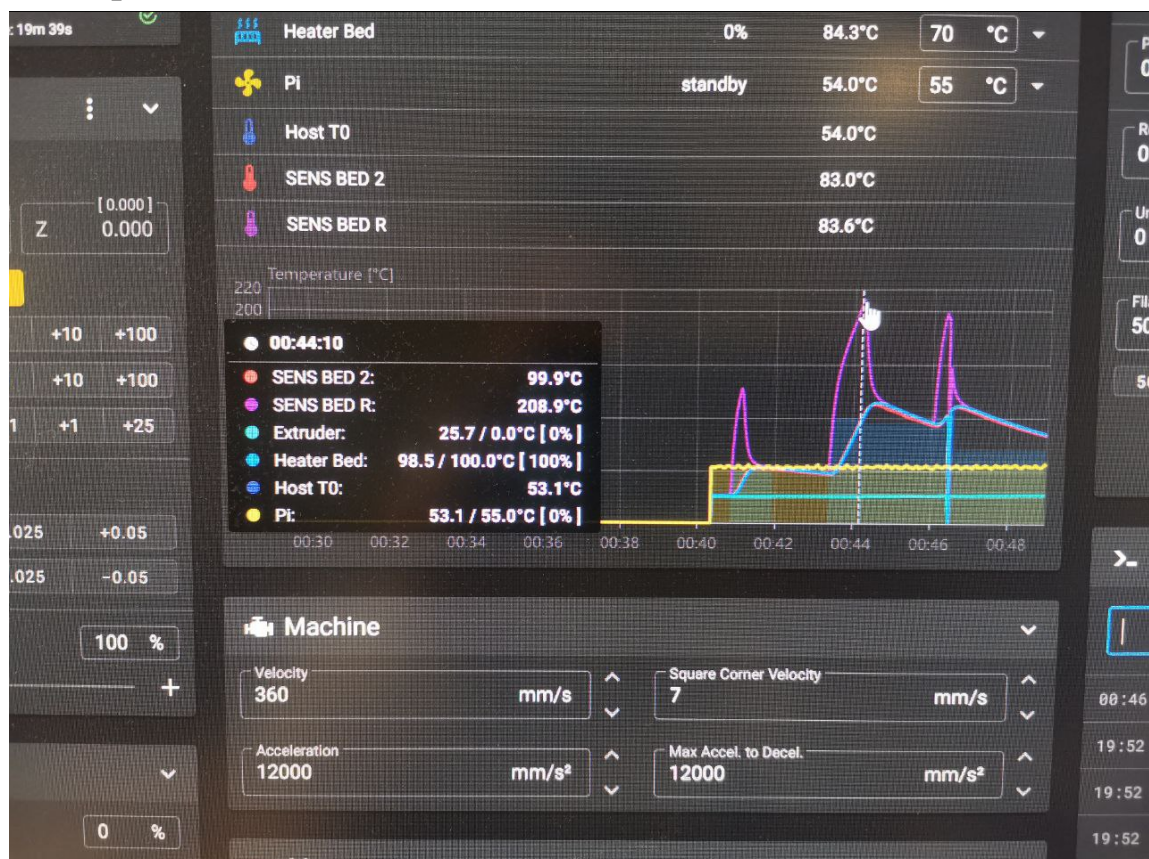
Рисунок 11 - пример неправильного управления нагревателем
