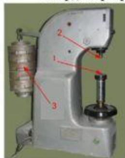
1 – предметный столик; 2 – оправка с индентором; 3 – грузы
