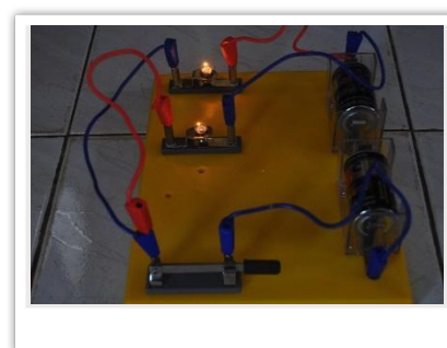
Gambar 8.11 Lampu menyala sangat terang karena jumlah baterai lebih banyak
