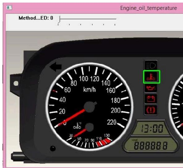
**Figure II.4.6** : Détection et localisation du témoin de la température de l'huile moteur
