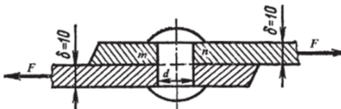
Рис. 28. К примеру расчета заклепочного соединения
