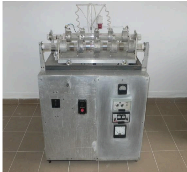
Рис.3 Схема та зовнішній вигляд установки для зонної очистки Те: 1 - кварцова труба, 2 - нагрівач, 3 - рухома основа, 4 - ролик, 5 - рама, 6 – опора
