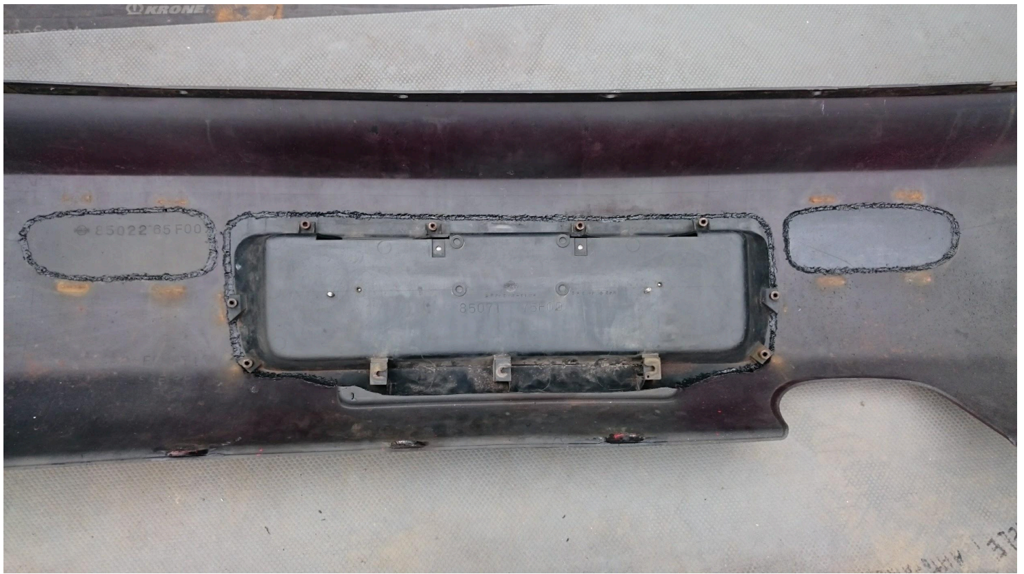
Takapuskurin sisäpuoli kolvailun jälkeen.
