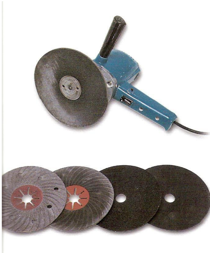
Pulidora eléctrica y diferentes discos de carborundo y diamantados.
