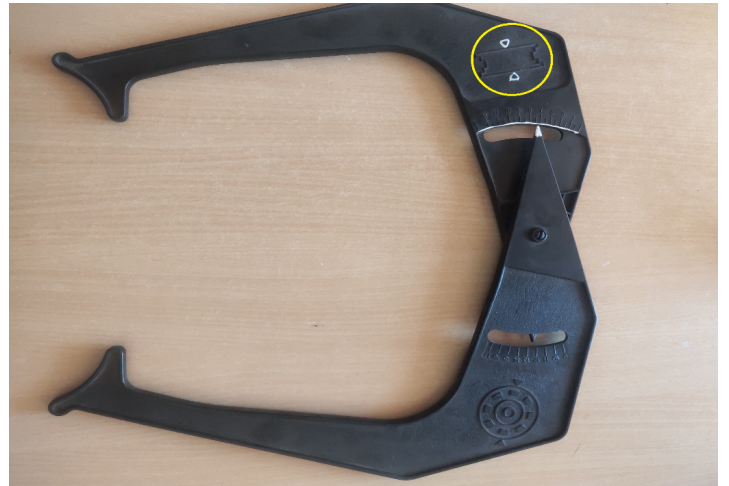
Hình 8: Thước đo bề rộng vành xe
