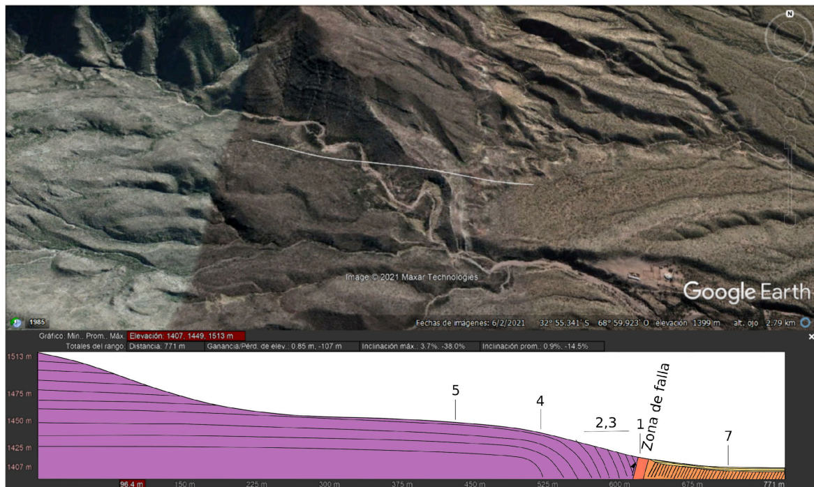
Figura 4. Perfil (corte vertical) mostrando la falla geológica (zona de falla), el plegamiento de las capas triásicas (puntos 2,3,4,5) y la discordancia entre capas miocenas y cuaternarias (punto 7).
