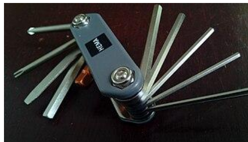
Багатофункціональний інструмент. Набір імбусових і ін. ключів для ремонту велосипедів
