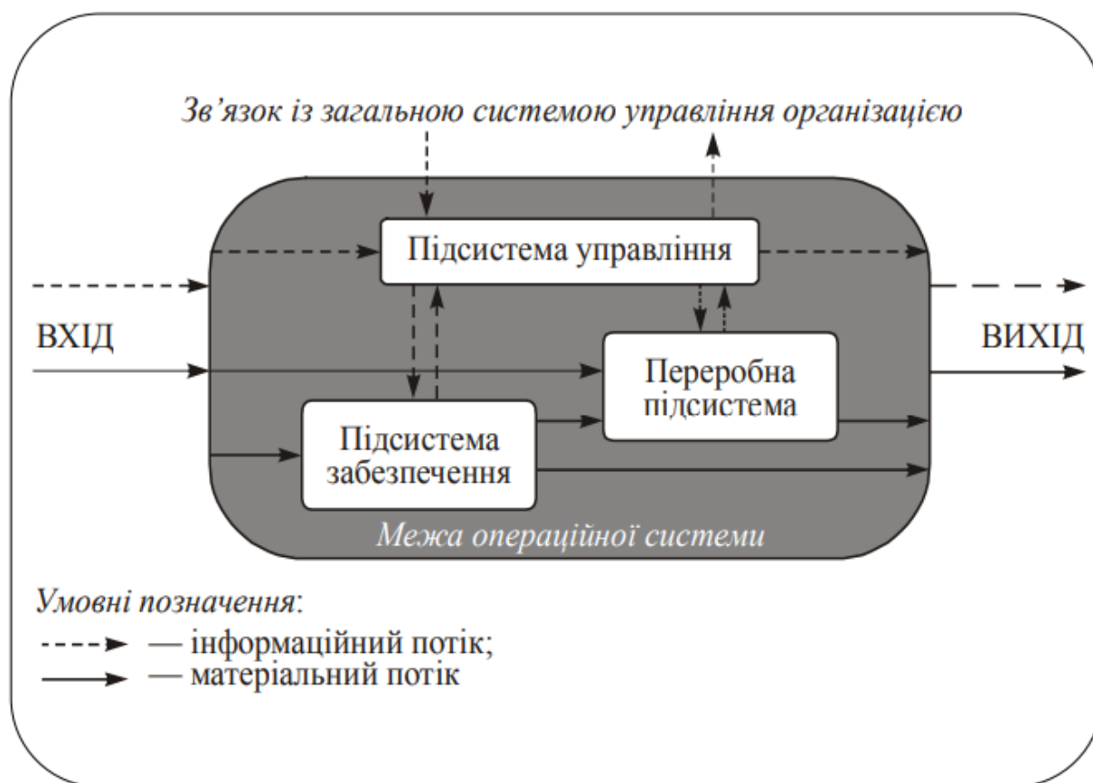
Рисунок 2.8 – Схема структури ОС
